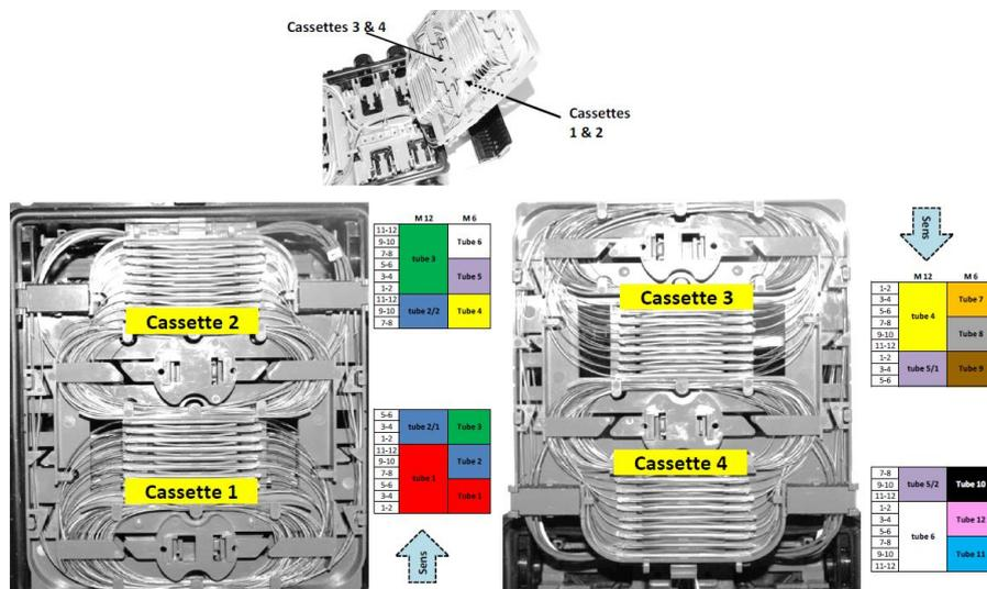
Par ailleurs, dans le cas où un  $\mu$ module est partagé entre 2 cassettes, on veillera à utiliser les mousses intérieures.
