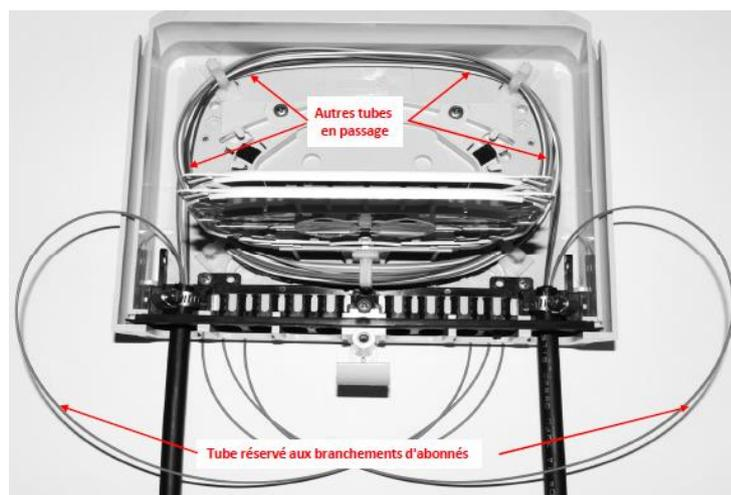
Les  $\mu$ tubes en passage sont lovés en dernier de façon à ce qu'ils puissent être extraits et retravaillés sans avoir à dé-câbler l'ensemble du boîtier (par exemple : récupération d'une FO supplémentaire Client Final sur tube non ouvert).
