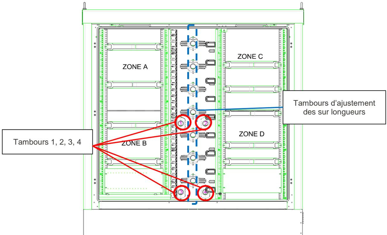
Les 4 tambours 1, 2, 3 et 4 représentés ci-dessus constituent des points fixes de passage des jarretières dans les différents scénarii de raccordements. Entre ces 4 tambours, sont disposés sur toute la hauteur du répartiteur 7 tambours. Ils permettent d'adapter la longueur de jarretière à résorber.
