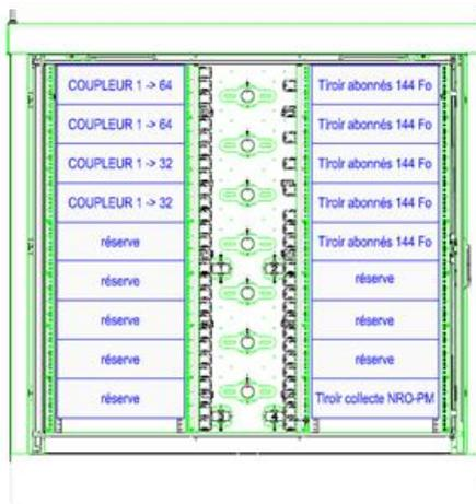
Les câbles optiques pénètrent au sein de l'armoire après passage dans la dalle supportant l'armoire. Chaque zone 19 pouces permet le passage de câbles de diamètre jusqu'à 17 mm. L'utilisation de presse étoupe garantit l'étanchéité de l'armoire.
