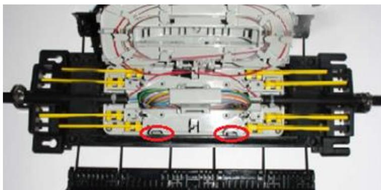
Le boîtier est fermé en prenant bien soin de positionner les bouchons, en s'assurant de l'état de propreté des joints et en vérifiant que les blocs gels couvrent bien tous les câbles et bouchons. Lorsque la boîte est fermée, le gel doit déborder.
